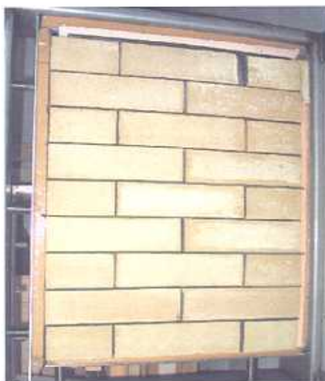
Figura 3: Pannello sottoposto a prova al termine dei cicli di gelo/disgelo
